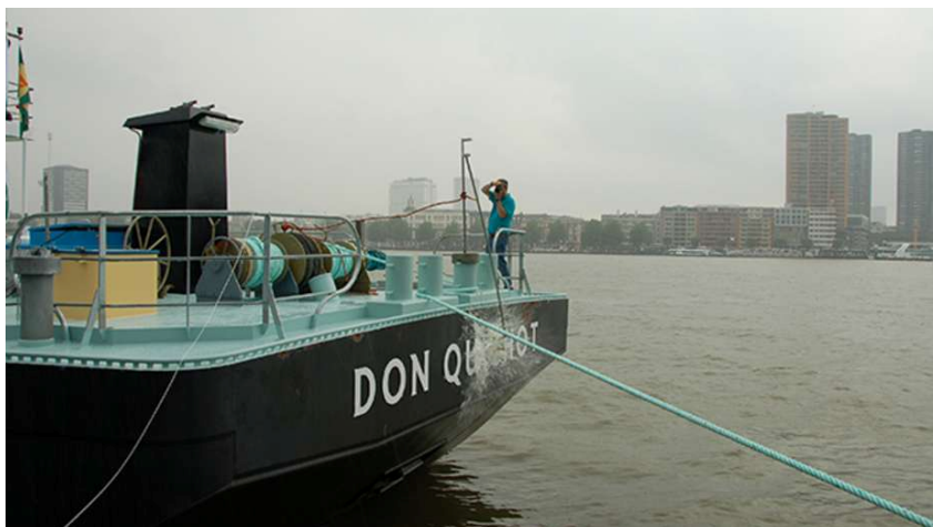
Erste schwimmende Entgasungsstation für Binnenschiffe: MTS Don Quichot (GreenPoint Maritime Services) Quelle: Hafen Rotterdam Mathijs Schoon
